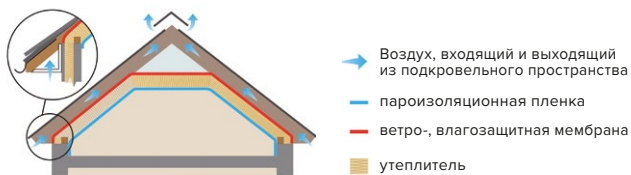
Рис. 4.1. Устройство вентиляции мансарды
