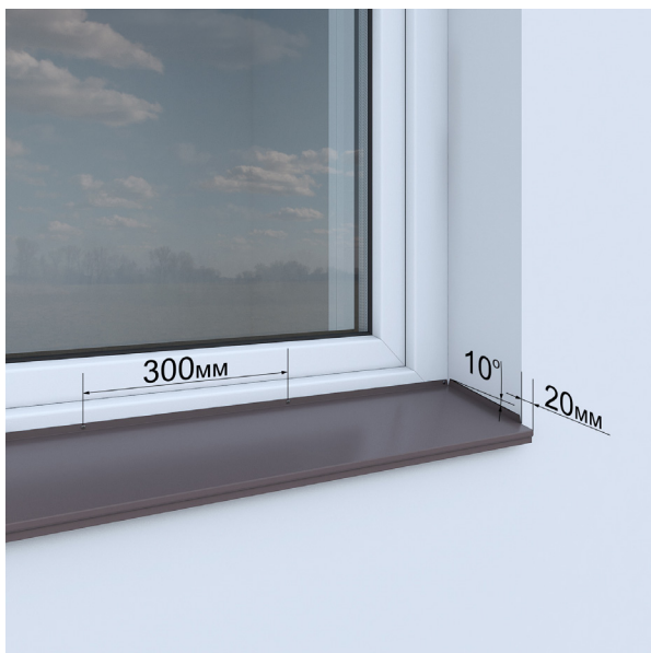
Рисунок 10.1 – Расположение оконного отлива
