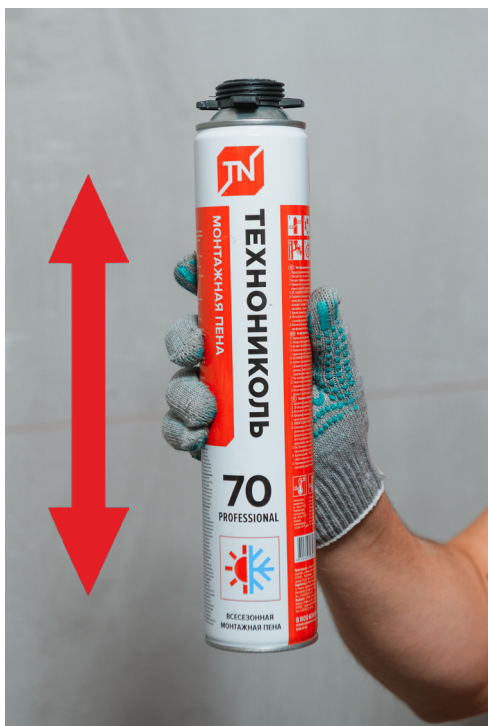
Рисунок 8.2 – Пример растряски баллона с монтажной пеной
