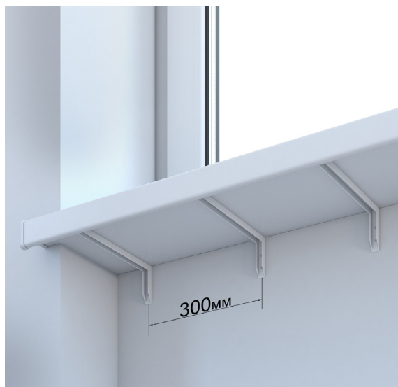
Рисунок 11.4 – Установка подоконника с применением опорных кронштейнов
