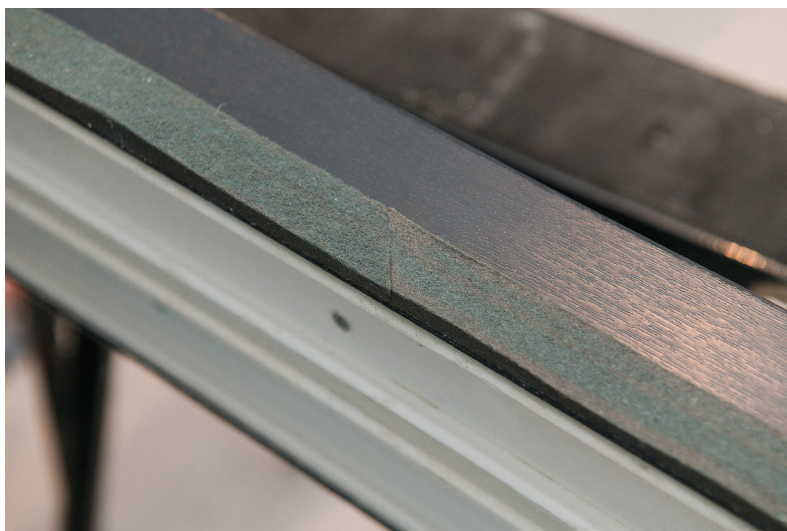
Рисунок 7.2 – Пример стыковки двух отрезков ленты на линейном участке
