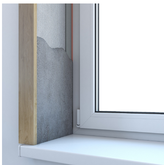
Рисунок 12.2 – Нанесение второго, верхнего слоя штукатурного раствора «по рейку»
